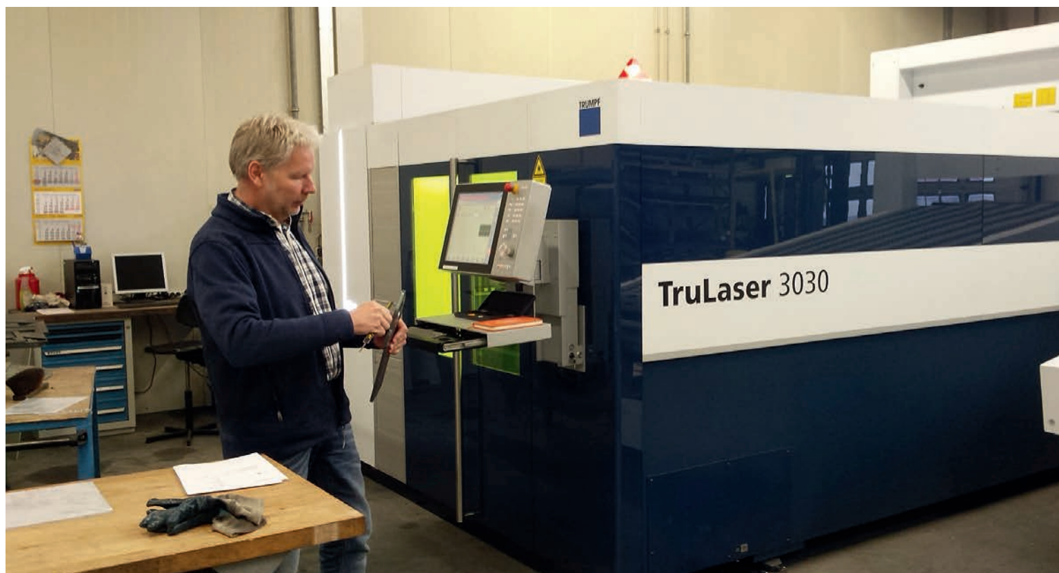
‘De machine heeft een snijbereik van 3000 x 1500 mm en is razendsnel, vooral in diktes tot 4 m’, zegt Jos Wemerman over de Trumpf 3030 Fiber.
